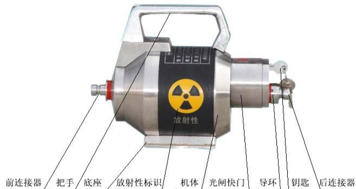
图 4-5 \gamma 射线探伤机源屏蔽容器(贮源容器)外部结构组成
